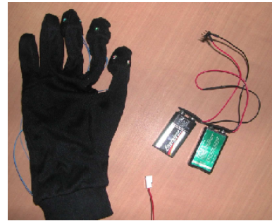
FIG. 5: Second prototype de gant : cinq diodes par doigt. On réduit considérablement les occlusions des diodes.
