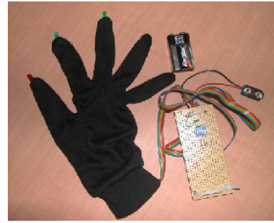
FIG. 4: Premier prototype de gant : une diode par doigt. Des occlusions peuvent avoir lieu.
